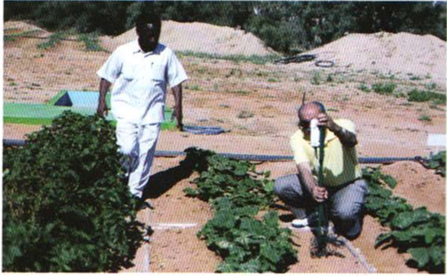
الصورة ٦: جهاز مراقبة الرطوبة والملوحة في التربة بوسط حقل البطاطس.
