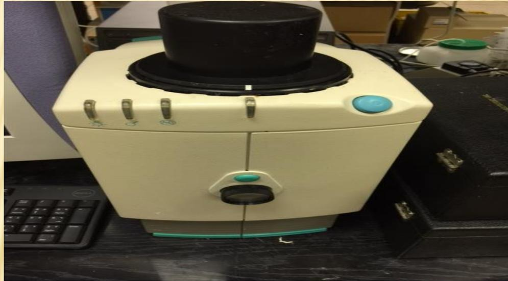
✘ الشكل (٨) جهاز ( Lab Scan XE, Hanter lab, US ) لقياس المركبات الأساسية للون.
