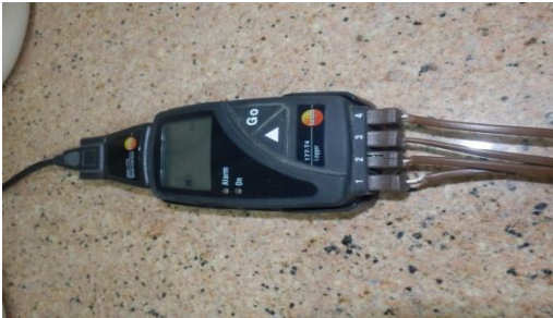
داتا لوجر وثيرموكابل Data-Logger and Thermocouple
