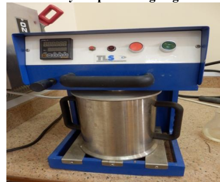
جهاز تجانس اللب Pulp Disintegration
