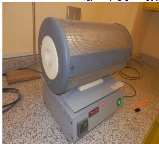
أنبوب الكربنة الحراري Carbonization Tube Furnace
