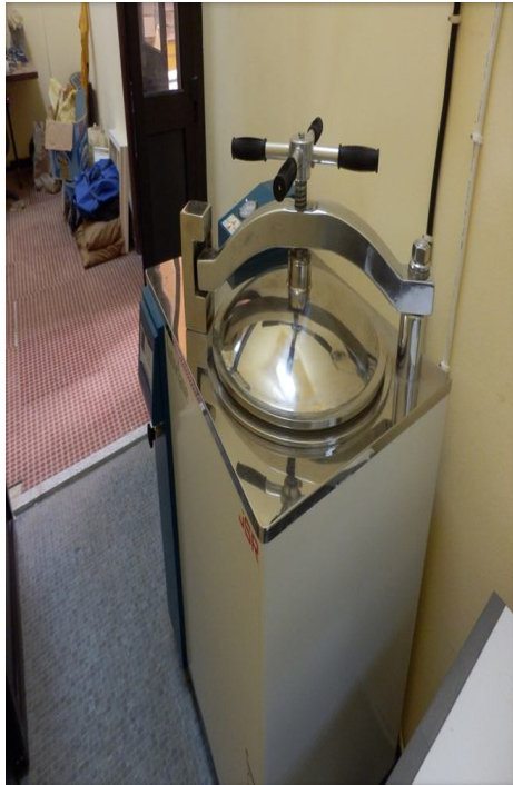
جهاز التعقيم- اتوكلاف Autoclave
