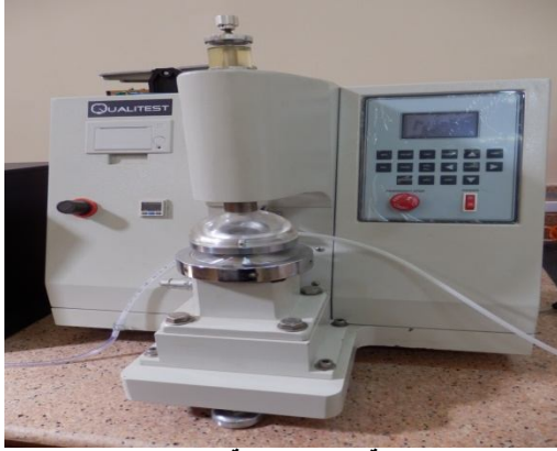
ماكينة اختبار مقاومة الانفجار Bursting Strength Tester
