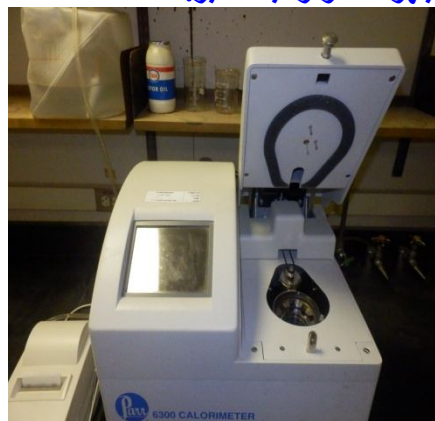
المسعر الحراري Calorimeter
