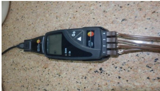
داتا لوجر وثيرموكابل Data-Logger and Thermocouple
