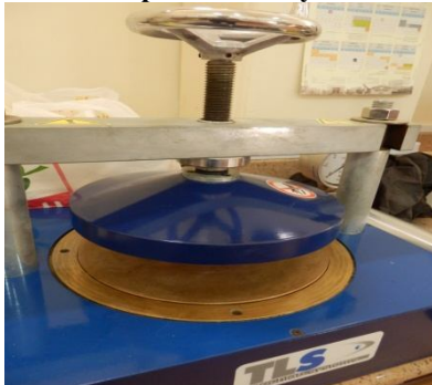
مكبس صناعة الورق Paper Sheet Press
