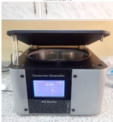
جهاز الطرد المركزي تحت تفريغ Centrifuge
