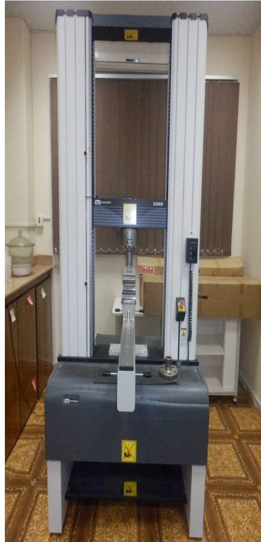
ماكينة اختبارات الأخشاب ومنتجاتها متعددة الأغراض Universal Testing Machine for Wood and its Products
