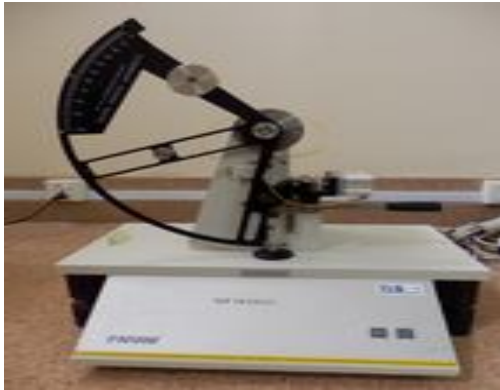
ماكينة اختبار تمزق الورق Tearing Tester
