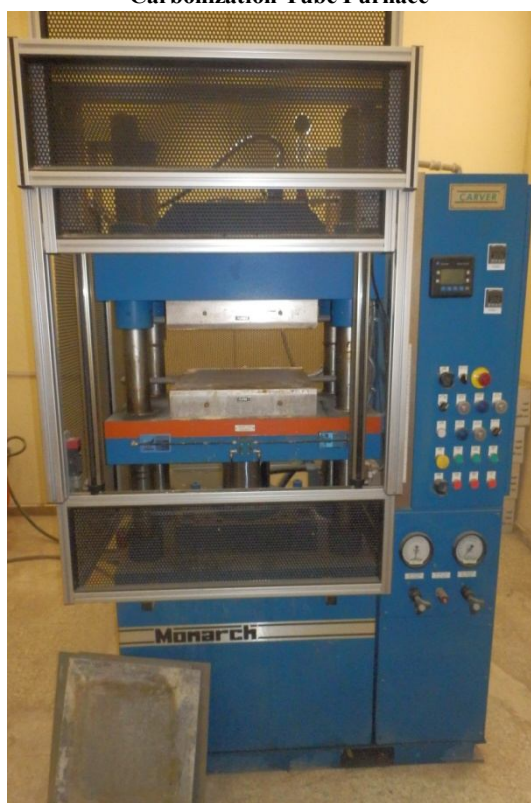
مكبس هيدروليكي ساخن/بارد Hot/cold Hydraulic Press
