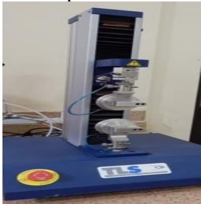
ماكينة اختبار شد الورق Multi-Tester
