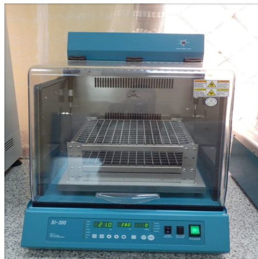
جهاز الحضان الهزاز Incubator Shaker
