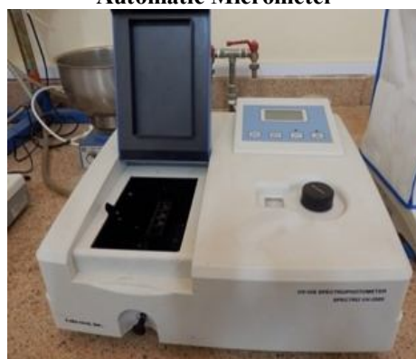
جهاز تقدير الطيف الضوئي Spectrophotometer
